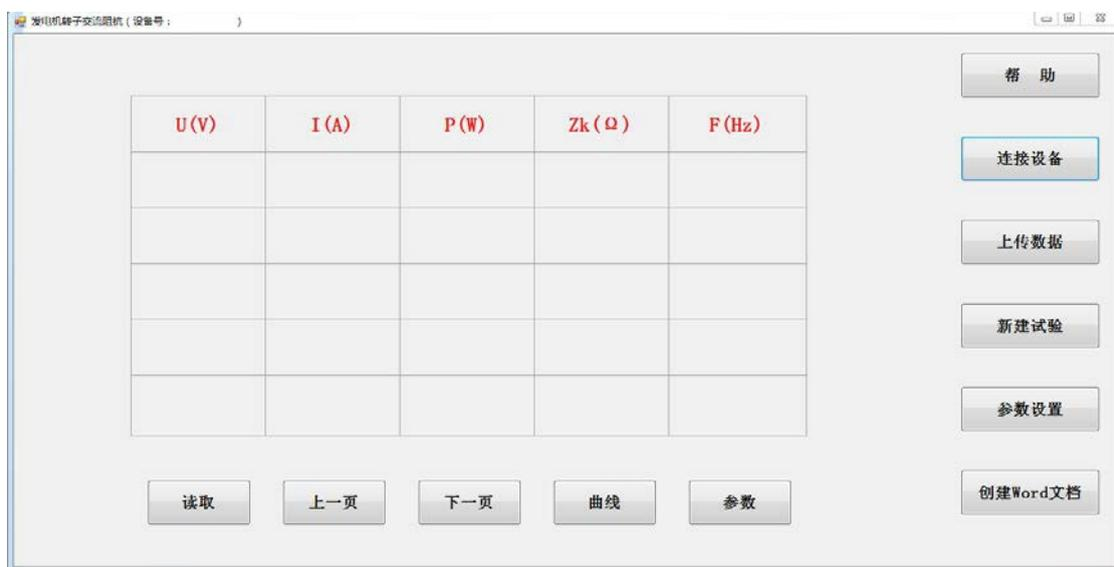
图 51 发电机转子交流阻抗联机界面
