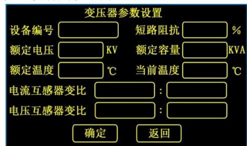
图 15 变压器参数设置界面
