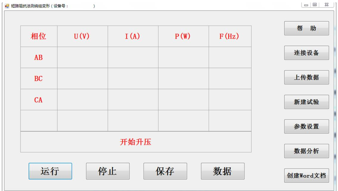
图 46 短路阻抗试验界面
