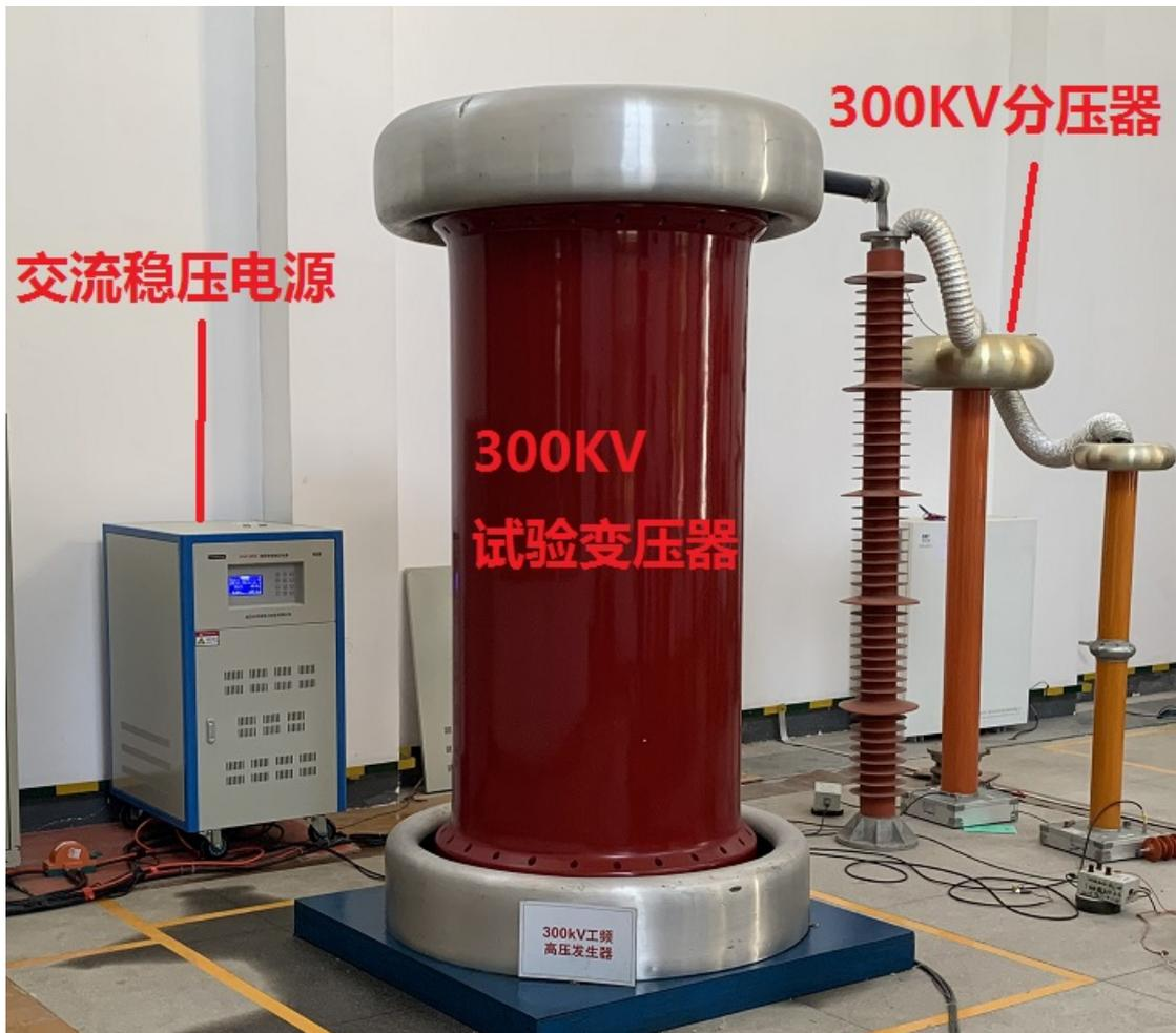
图 3 交流稳压电源 变压器 分压器实物连接图
