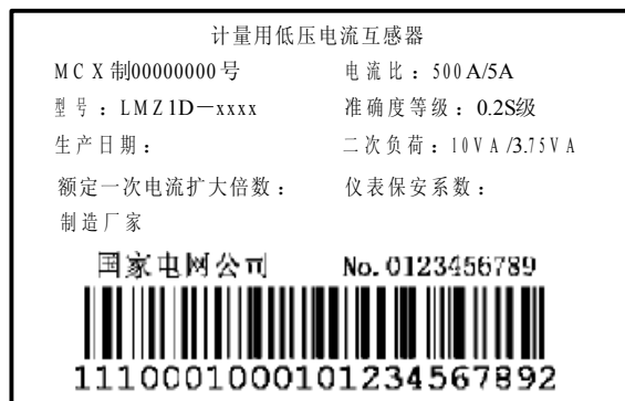
图 2 国网公司计量用低压电流互感器铭牌式样
